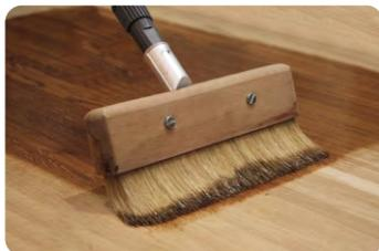
Продукт тщательно перемешать. Наносить кистью, щеткой для пола или валиком тонким равномерным слоем. Через 30-40 мин разровнять (распределяя продукт с менее впитывающих участков на более впитывающие) или убрать излишки масла с поверхности. Нанесение при помощи дисковой машины. Поместить небольшое количество продукта в центр белого пада (во избежание разбрызгивания). Равномерно распределить материал по всей поверхности.
